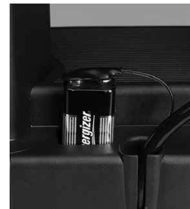
Batería monobloc de 9 V para el descenso de emergencia
