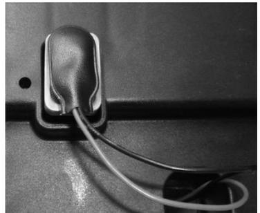
9-V-Blockbatterie für die Notabsenkung (Doppelantrieb)
