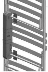
Schieben Sie die Deckplatten seitlich in die Arretierung des Doppelantriebs.
