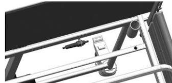
Setzen Sie den Aufrichter in die Halterung ein. Achten Sie darauf, dass er mit der Nut arretiert ist.
